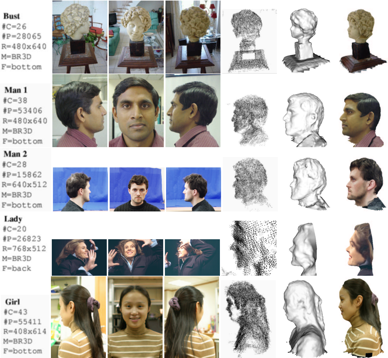
FIG. 5 – Chaque ligne montre le résultat pour un exemple. De gauche à droite: quelques détails expérimentaux, 3 images de la séquence, points quasi-denses reconstruits, rendu de Gouraud pour la surface, rendu avec texture pour la surface. Pour les détails expérimentaux, \#C est le nombre de caméras, \#P est le nombre de points 3D, R les dimensions des images, et F la position du plan réduisant le domaine d'évolution de la surface. Le temps de calcul pour l'évolution de surface est d'environ 5 minutes sur un P4 à 2.4 Ghz.
