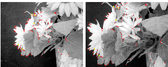
FIG. 8 – Mise en correspondance entre deux images où le changement d’échelle est de 1.5.
