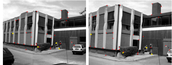
FIG. 10 – Mise en correspondance entre deux images où le changement d'échelle est de 1.4. Un faible déplacement de la caméra a été effectué entre les deux images.
