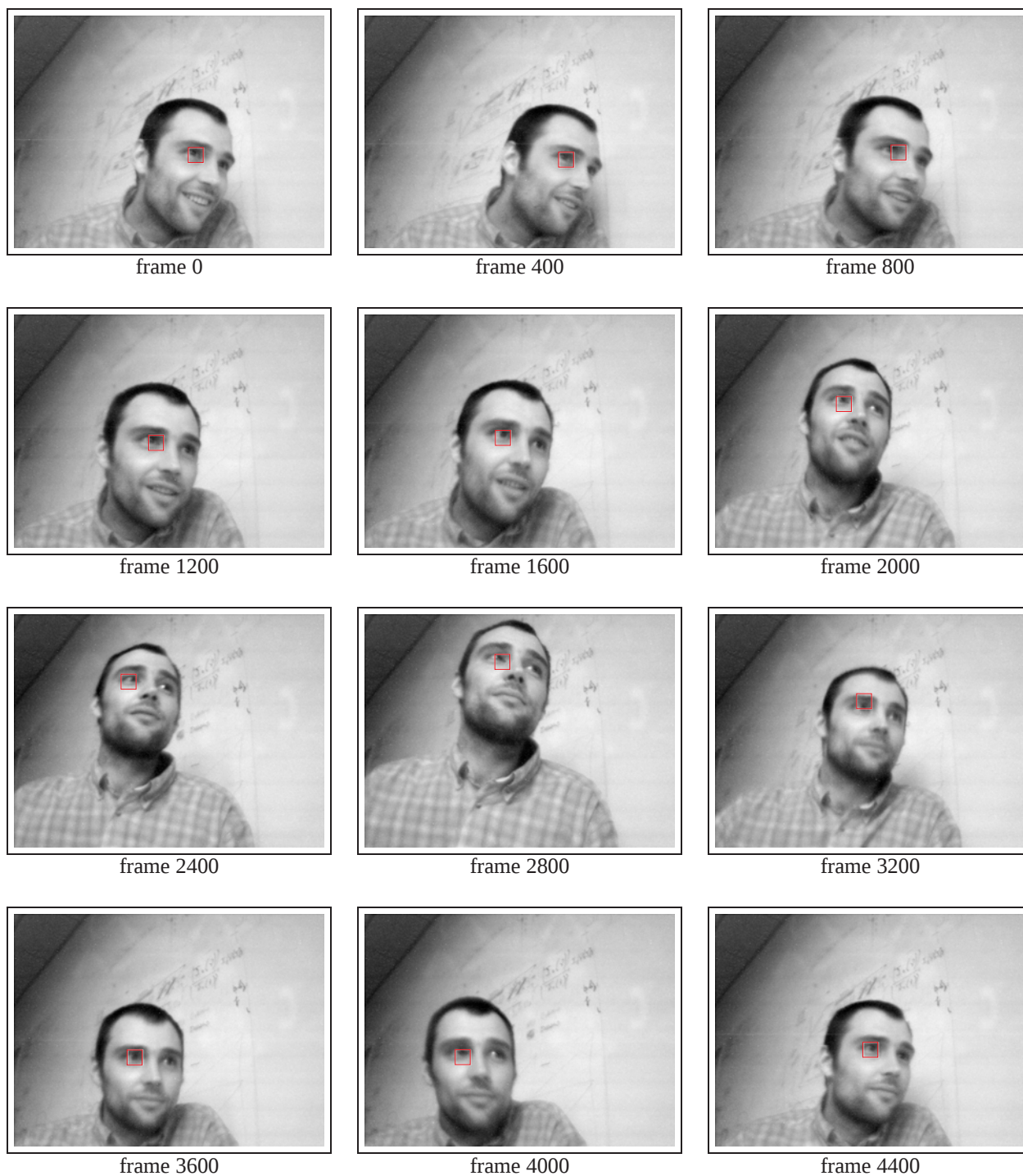
FIG. 9 – Suivi d'un motif de niveaux de gris de dimensions 32 \times 32 pixels. L'intervalle de temps entre deux images entières vaut 720 ms. La position du motif est actualisée toutes les 1.8 ms.
