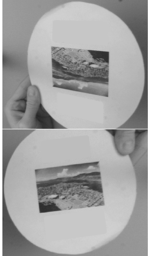
FIG. 4 – Représentation d’une image issue d’une vidéo (à gauche) qui est rectifiée de manière à rétablir sa structure Euclidienne en utilisant les résultats de l’auto-calibrage (droite). Notons que la zone rectangulaire est correctement reconstruite.
