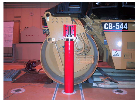
Fig. 5. Bridage du châssis sur le massif sismique
