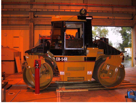
Fig. 7. Montage du compacteur sur chandelles
