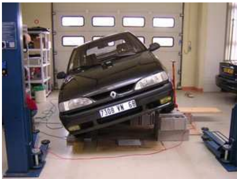
Fig. 7. Mesure du centre de gravité
