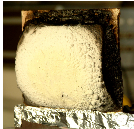
Fig. 3. Système intumescent multicouche après réaction face à un flux radiatif
