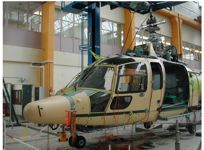
Fig. 2. Vue d'un essai d'identification modale
