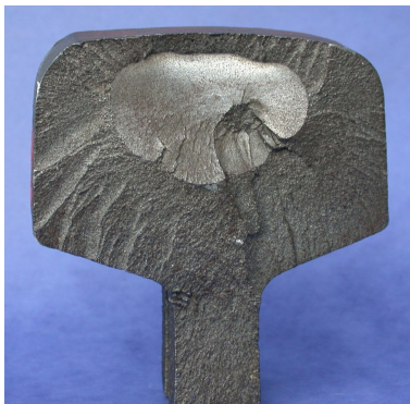
Figure 1 : Illustration d'un défaut interne.
