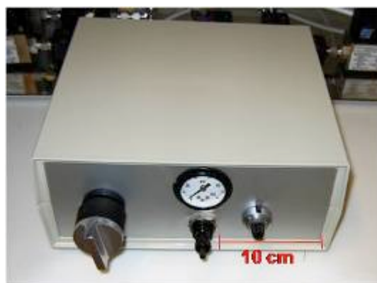
FIG. 13 : Démonstrateur de laboratoire en cours de réalisation avec le couplage d'une micro-colonne et d'un capteur SnO 2 .
