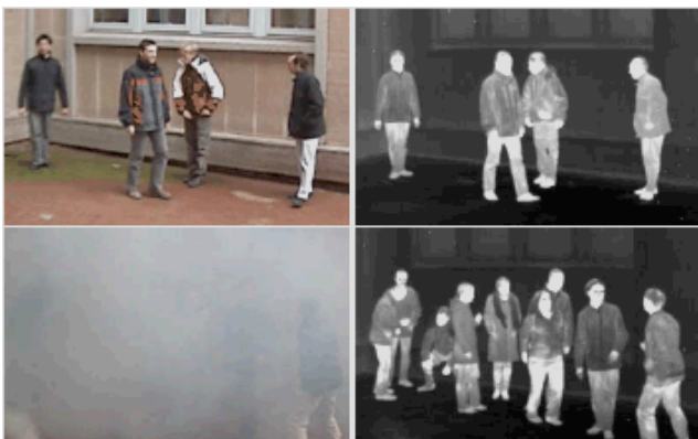
FIG. 1: Influence de la fumée dans des images couleur et infrarouge. Haut sans fumée, bas avec fumée
