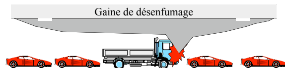
Figure 5 : Ventilation transversale en tunnel.
