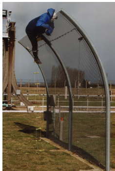
FIG. 1 : Barrière de tests de système de sécurité périmétrique (photo CEA)
