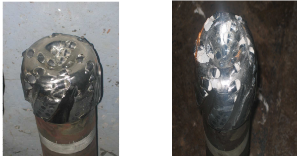
Fig. 2. Trépan, de gauche à droite sans et avec bourrage
