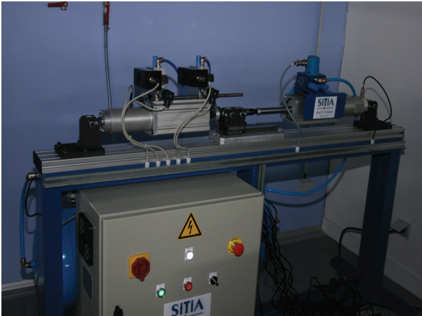
Fig. 1. Installation électropneumatique de l'IRCCyN - A gauche l'actionneur "principal" dont la position est commandée. A droite, l'actionneur de "perturbation" dont la force est commandée.
